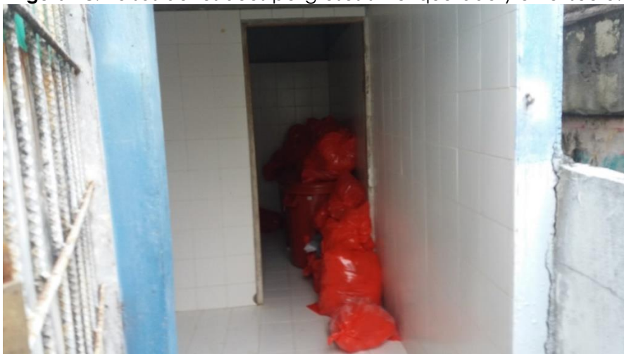
Figura 18. Bolsas de residuos peligrosos sin etiquetado y en el suelo.
