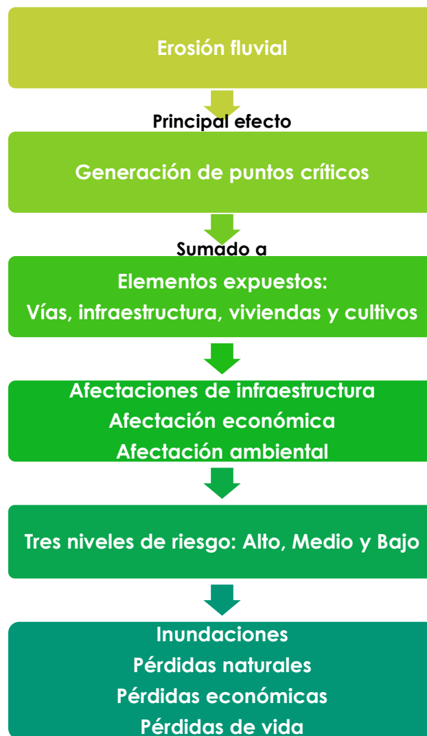
Figura 23. Resumen de la identificación de las afectaciones por erosión fluvial
