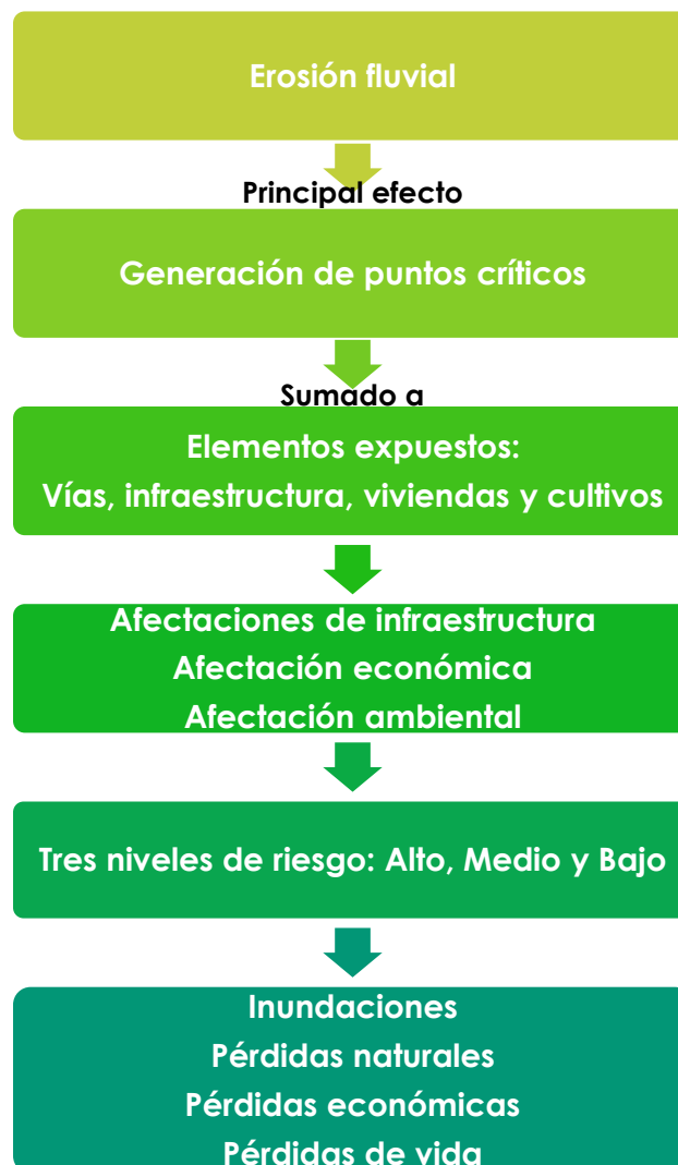
Figura 27. Resumen de la identificación de las afectaciones por erosión fluvial
