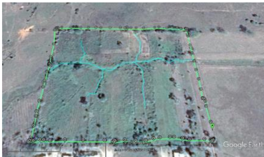
Parcela 129 corregimiento de Vialanueva Municipio de Valencia. Georreferenciación de vértices y recorrido realizado.
