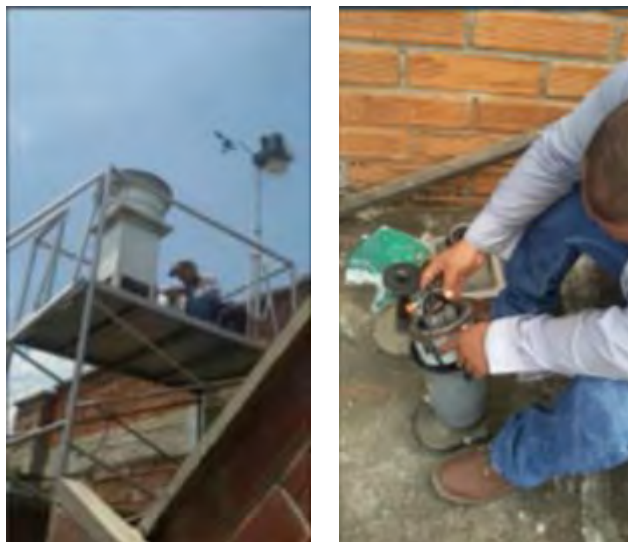
Limpeza a entradas de ductos, revisión de motor, cambio de escobillas, verificación eléctrica, marcador de flujos y programados - UNISINÚ
