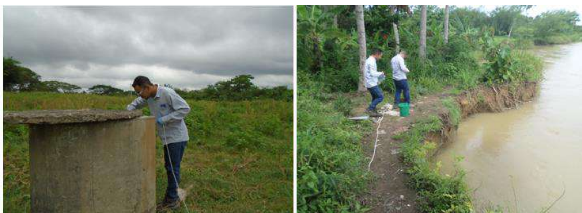
Ilustración 35. Toma de muestras Pozo de Agua Subterránea Lórica. Vs Toma de muestras Agua Superficial (San Jorge). Fuente: Laboratorio de Aguas del Caribe, 06/07/2023
