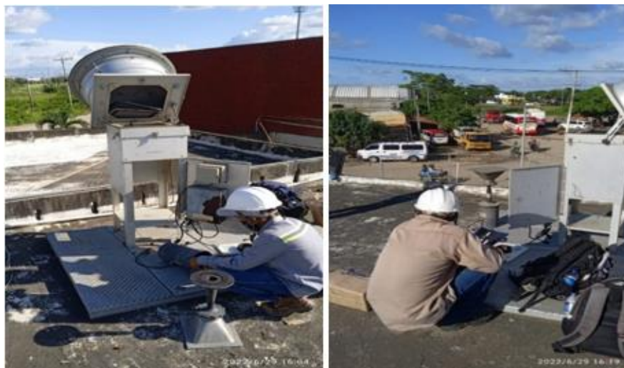
Ilustración 173. Mantenimiento de equipos HI-VOL MP10. Fuente: Equipo técnico SGA, 2022
