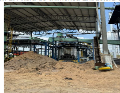
Imagen 4. Multi-ciclón para control de emisiones
