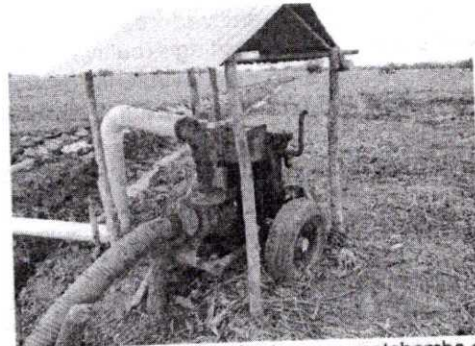
Figura # 8. Punto de captación de agua, motobomba de 8" y de tubería de conducción de agua
