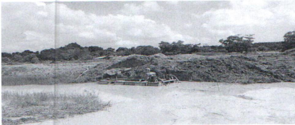
El tipo de explotación realizado en el sitio, es a cielo abierto sin frente definido ni planteamientos mineros, realizando cortes y arranques mediante excavadoras y lavado gravimétrico mediante motobombas y canaletas. El agua necesaria en el proceso es tomada de reservorios superficiales construidos antrópicamente sobre el lecho de la fuente superficial.
