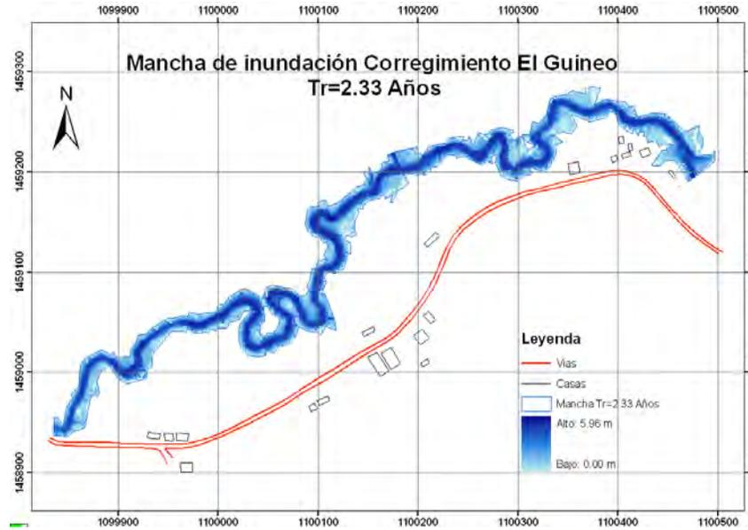
**Figura 96.** Manchas de inundación para la quebrada el guineo tramo 1 Tr=2.33 años
