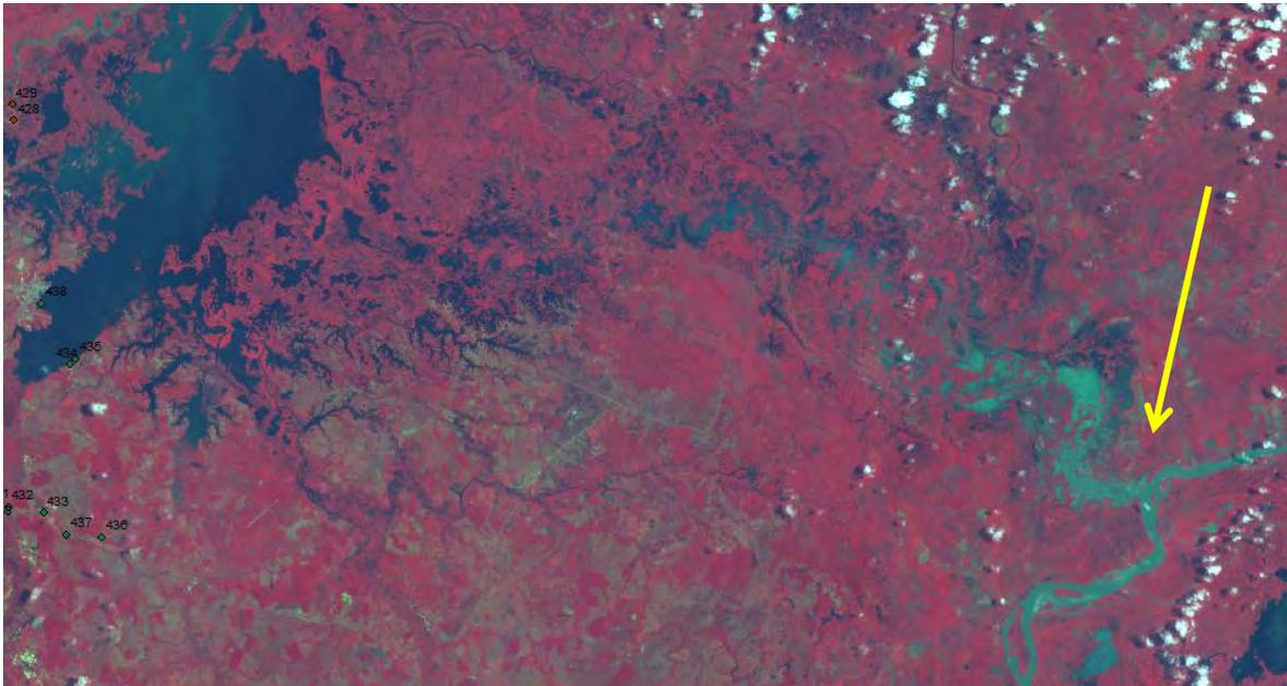
**Figura 37.** Imagen satelital donde se observa la ruptura del dique del río Cauca al oriente de Ayapel, en el sitio denominado Boca de Santa Anita, obsérvese como ingresa un caudal importante por esta abertura hacia el complejo cenagoso
